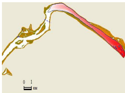
Рис. 2.2. Расчет полыньи в нижнем бьефе Новосибирской ГЭС
