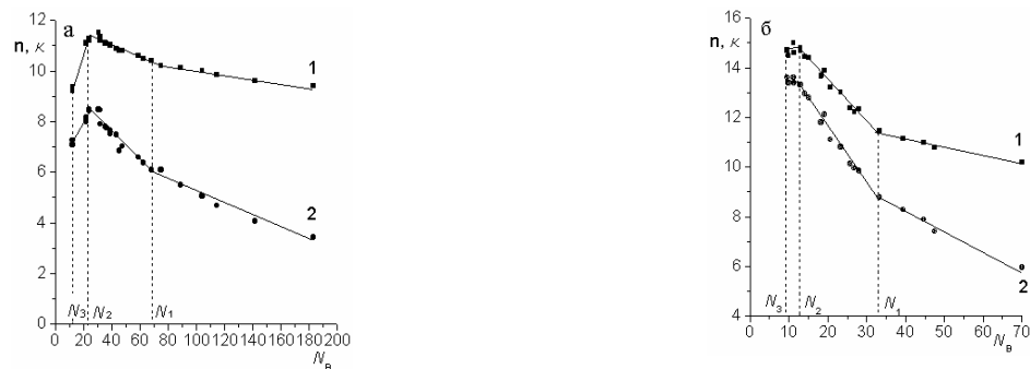
Рис. 18. Зависимости показателей преломления n (1) и поглощения k (2) водных растворов солей Na_2CO_3 (а) и NaCl (б) от числа молекул N_B , приходящихся на единицу массы безводной соли
