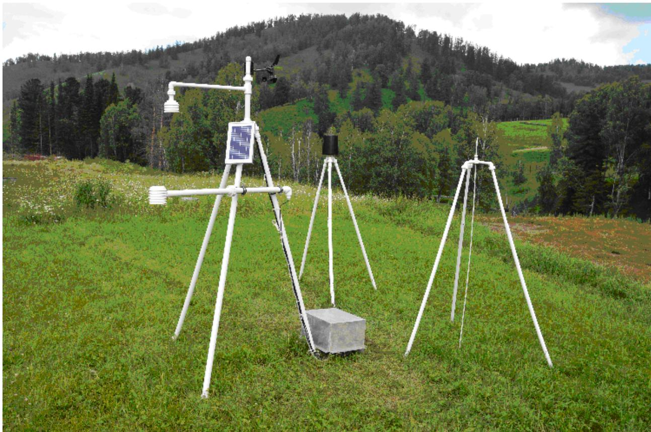
Рисунок 3.2 – Расположение датчиков на примере пункта наблюдения № 1 (с. Урлу-Аспак)
