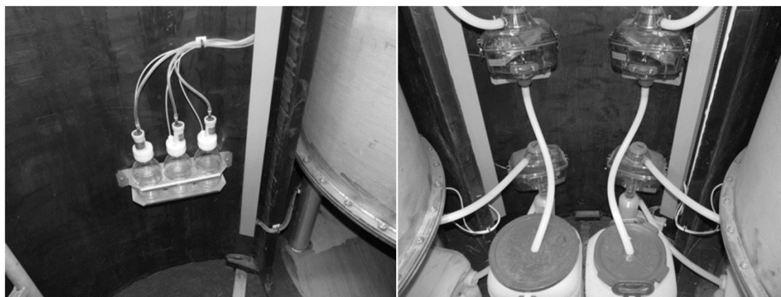
Рис. 3 – Емкости для сбора лизиметрических вод, поверхностного и почвенно-грунтового стока
