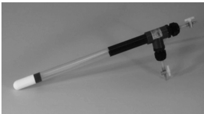
Рис. 1 – Устройство для извлечения почвенного раствора с керамическим наконечником (suction probes with ceramic cup)
