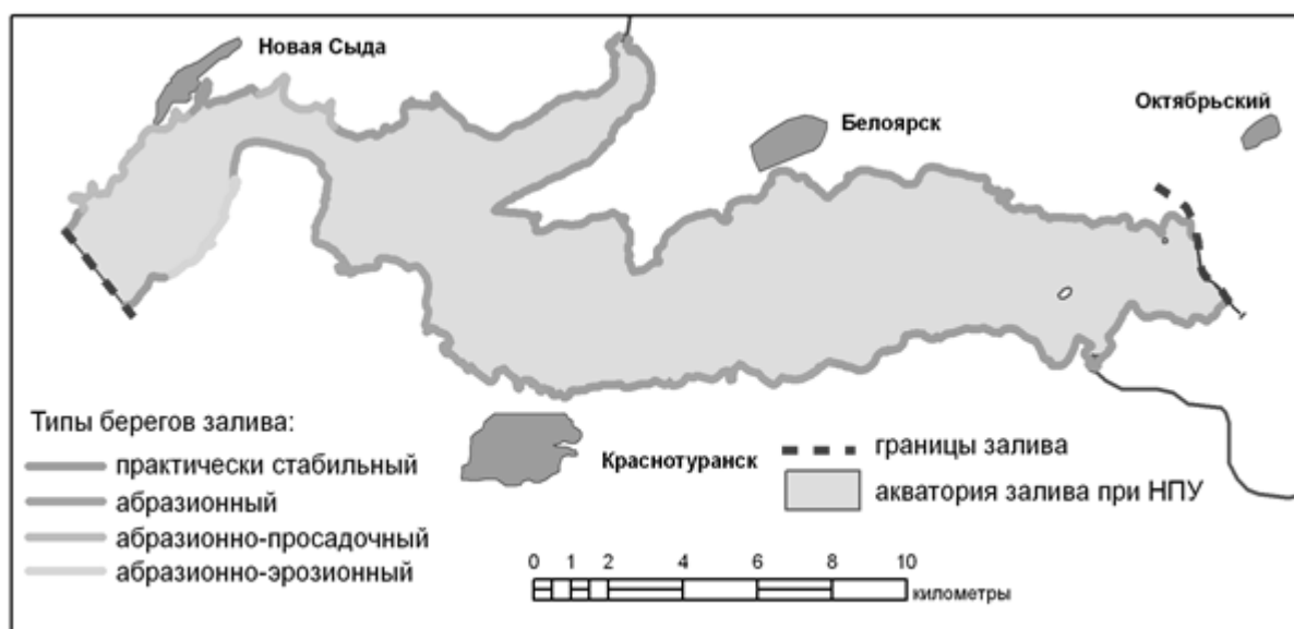
Рис. 2 – Состояние берегов залива Сыда по результатам обследования в июне 2013 г.
