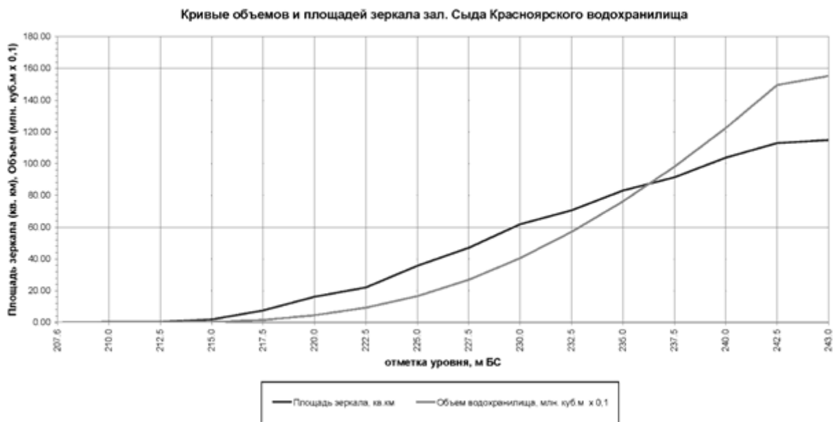
Рис. 4 – Кривые объемов и площадей зеркала зал.Сыда
