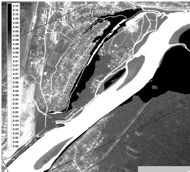
Рис. 5 – Зонирование области моделирования по коэффициенту шероховатости
