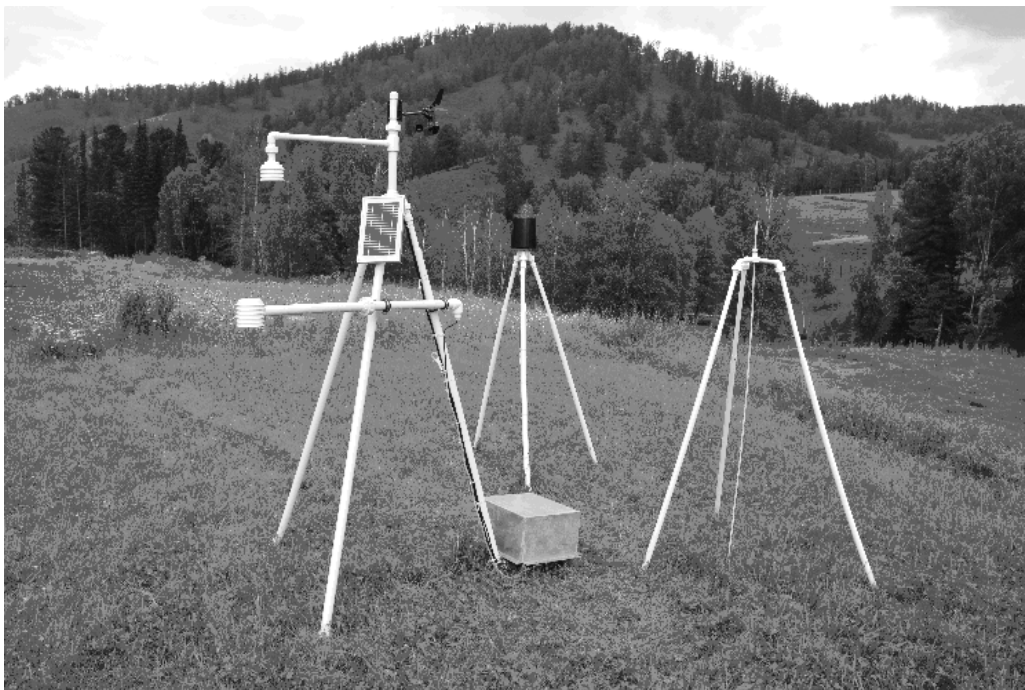
Рис. 2 – Расположение датчиков на примере точки наблюдения №1
