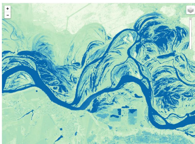
Рис. 1 – Результат вычисления индекса NDWI по данным Sentinel-2, 3 мая 2017 г. вблизи города Барнаул
